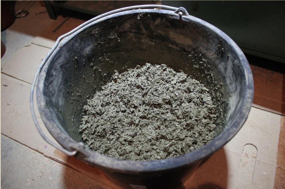
Holzbeton nach Anleitung erdfeucht anmischen
